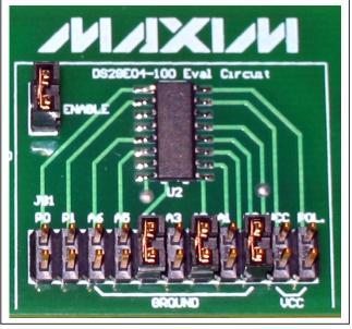
Figure 5. DS28E04-100 Evaluation Circuit
